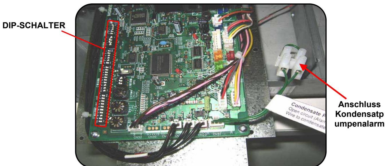
Überprüfen Sie, dass die DIP-Schalter auf der Schnittstellenplatine wie in Schaltplan 1 oder 2 auf Seiten 18 und 19 gezeigt eingestellt sind. Der SW2 Leistungseinstell-DIP-Schalter muss wie folgt eingestellt sein:
