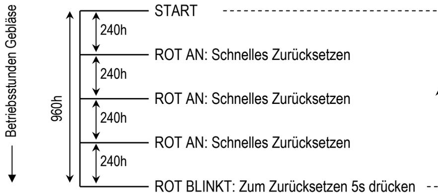
Diese vom Werk vorgegebene Einstellung ist für die meisten Anwendungen geeignet. Wie häufig das Gerät jedoch gereinigt werden muss, hängt von den vorliegenden Umgebungsbedingungen ab. Zwei alternative Zeitpläne sind verfügbar und können durch Ändern der Steckbrückenpositionen (markiert 1, 2 oder 3) auf der Filteranzeigeplatine eingestellt werden.
