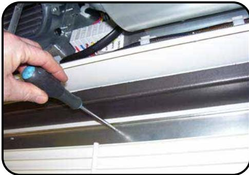
Lösen Sie die Reihe der Schrauben, mit denen die Luftführung befestigt ist (siehe Bild), und die Luftführung in den Schlitzen hochziehen. Diese Schrauben aber nicht ganz entfernen.
