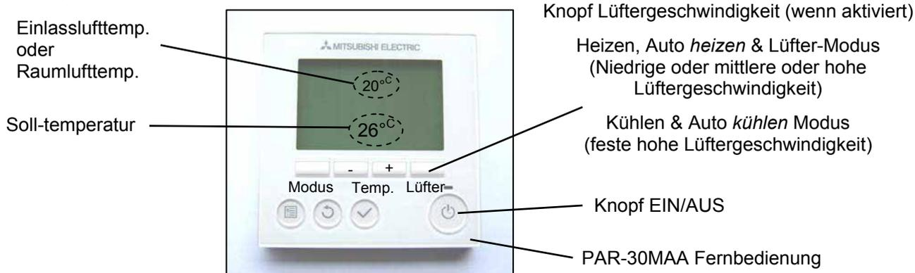
Schalten Sie den Luftvorhang durch Drücken des EIN/AUS-Schalters der Fernbedienung AUS und die Gebläse des Luftvorhangs stoppen. Schalten Sie nicht, wenn **Heizen Abtauen** zeigt auf dem Bildschirm, warten Sie, bis 3 Minuten nach dem Abtauen beendet ist.
