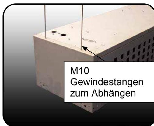
In der Oberseite des Gehäuses befinden sich Löcher (Positionen siehe Abbildung 1, Seite 12), durch die das Gerät mit M10 Gewindestangen (nicht im Lieferumfang enthalten) abgehängt werden kann. Das HP1000R Gerät hat 4 Abhängpunkte und die HP1500R und HP2000R Geräte haben 5 Abhängpunkte - alle Abhängpunkte müssen benutzt werden.
