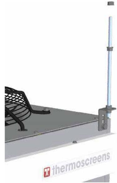
**HINWEIS:** Stellen Sie sicher, dass das Gerät in beiden Richtungen gerade und waagrecht hängt.
