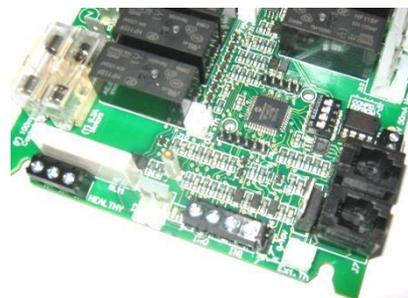
Richten Sie die an der Unterseite der zwei Nylonbefestigungsstützen angebrachten Modbus-Platinen-Befestigungsklammern mit den beiden Befestigungsbohrungen an der Ecopower-Platine aus, siehe Figure .
