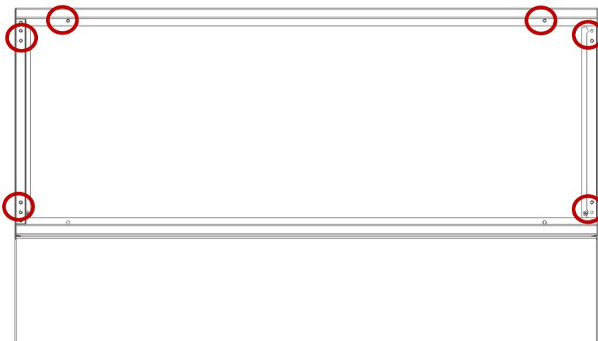
**Étape 3** À l'aide d'un tournevis à tête pozi, dévissez les autotaraudeurs qui maintiennent ensemble le plénum d'entrée à la barre d'éléments.
